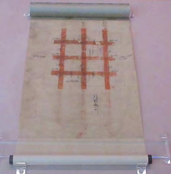
首の本殿の平面図。巨木3本を束ねた直径3mの柱が
